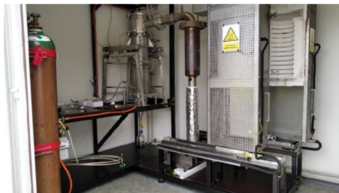
Obr. 3. Jednotka pro středněteplotní termickou pyrolýzu v AdMaS
