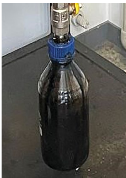
Obr. 4. Materiálová transformace celulózevéch pelet procesem pyrolýzy na pyrolýzní olej (vlevo) a pyrolýzní plyn (vpravo)
