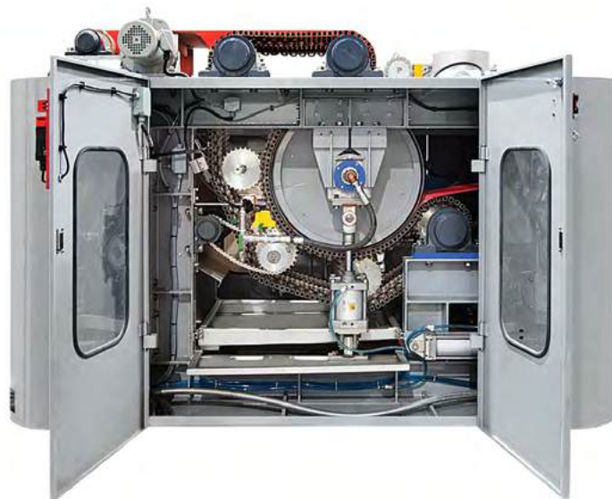
Obr. 3. Pohled do technologie MP-EDW – Hlavní oběžný buběn a oběžný pás
