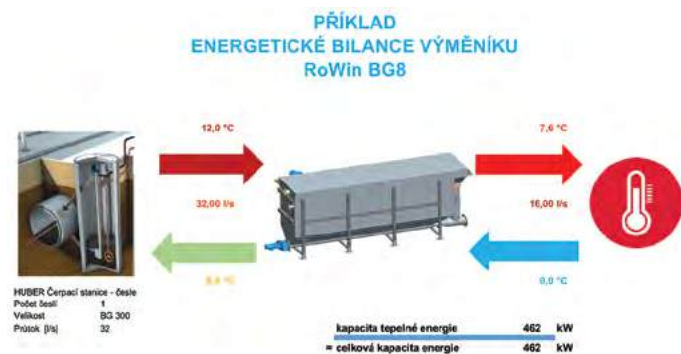
Obr. 1. Příklad energetické bilance tepelného výměníku HUBER RoWin
