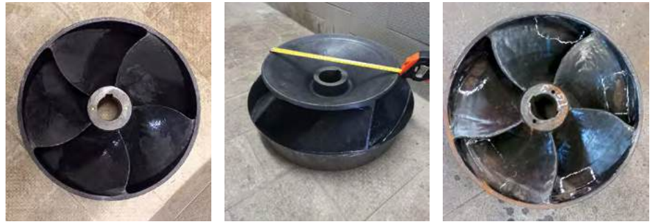
Obr. 2. Původní oběžné kolo čerpadla
