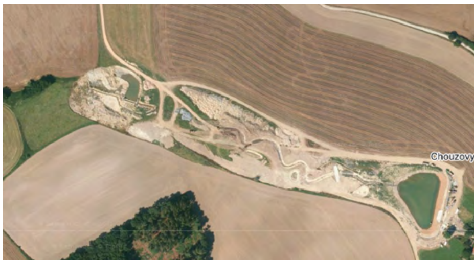
Obr. 2. Lokalita deprese v linii soustředěného odtoku vody po stavbě polyfunkčního zařízení dvou malých nádrží, třech tůň a revitalizovaného trubního kanálu. Kritický profil na hranici se zastavěnou částí obce (intravilánem) je vpravo pod dolní vodní nádrží
