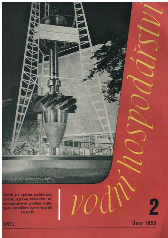
Obr. 2 (vpravo). Ročník 1959, únorová obálka s popisem: Oběžné kolo Kaplanovy turbíny pro vodní dílo „Orlík“ na světové výstavě v Bruselu
