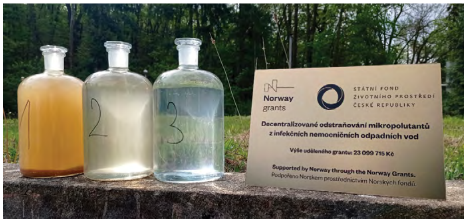
Obr. 6. Odběr vzorků vody v den předání technologie objednateli – 16. 4. 2024. 1 – přítok na biologický stupeň po mechanickém předčištění; 2 – odtok z dosazovací nádrže; 3 – vycištěná odpadní voda po průchodu pilotní jednotkou pro odstraňování mikropolutantů.
