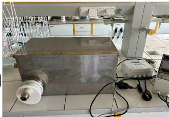
Obr. 2. Vľavo zjednodušená schéma UV dezinfekčného zariadenia (uvedená schéma je pre výšku hladiny 1 cm a objem OV 1,56 l); vpravo je fotografia zariadenia, v ktorom boli vykonané dezinfekčné testy
