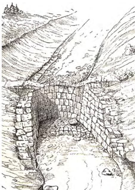
Přehrážka podle příručky pro lesnictví – Bystřiny a laviny, jejich vlastnosti, postavení a hrazení [2]
